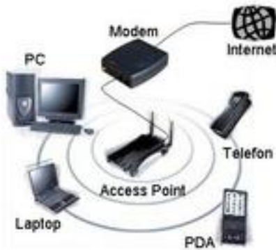
Figur 1: Verschiedene Geräte sind über den Access Point miteinander und durch das Modem mit dem Internet verbunden.
